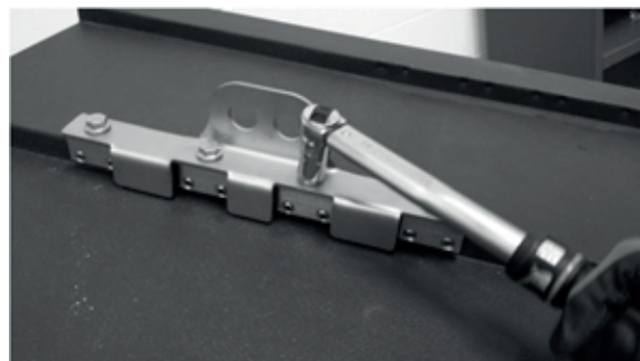
6 – SERRAGGIO BULLONI M10 (n°4 X 20 Nm)
